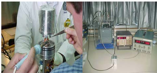
Fig. 1: Reparación de detector semiconductor y calibración de dosímetro clínico
